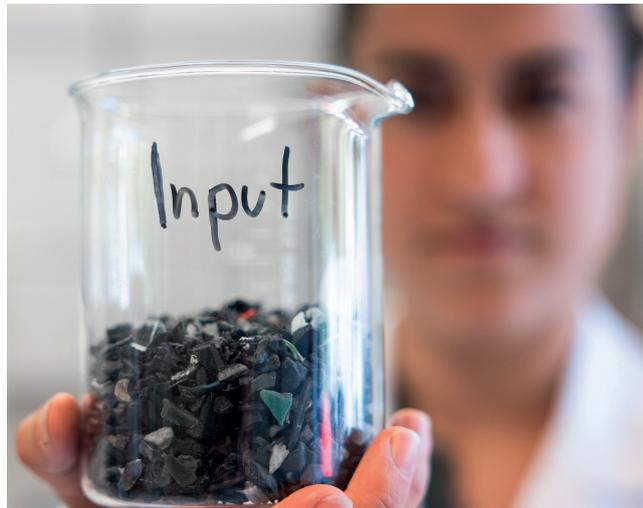
**Bild 1.** Kunststoffabfällen aus Automobilen bestehen häufig aus unterschiedlichen Polymeren. Beim lösungsmittelbasierten Recycling werden einzelne Kunststofftypen durch spezielle Lösemittel herausgelöst. © Audi
